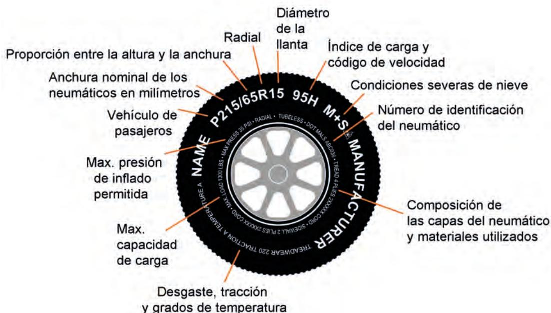
Imagen 54. Partes de un neumático
