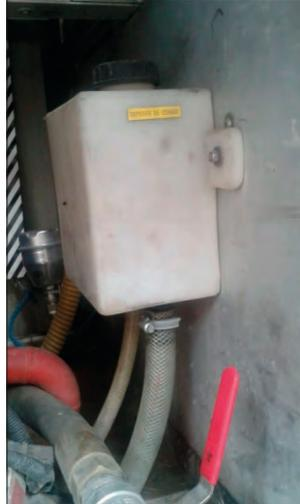
Imagen 42. Depósito de agua del sistema de cebado
