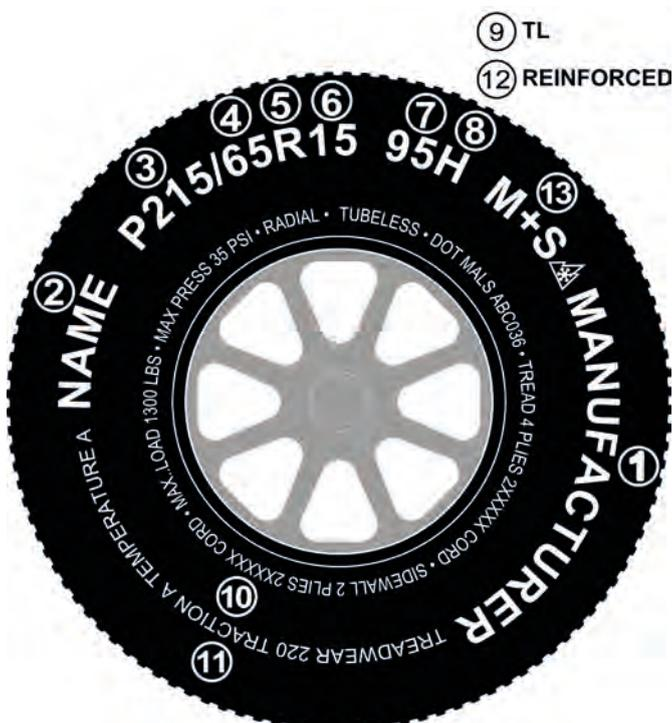
Imagen 55. Elementos de identificación de un neumático
