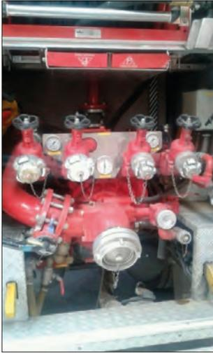
Imagen 41. Bomba con sistema de anillo de agua
