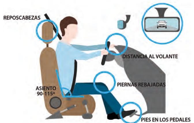
Imagen 57. Ajuste del asiento del conductor
