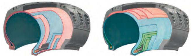
Imagen 53. Estructura de un neumático
