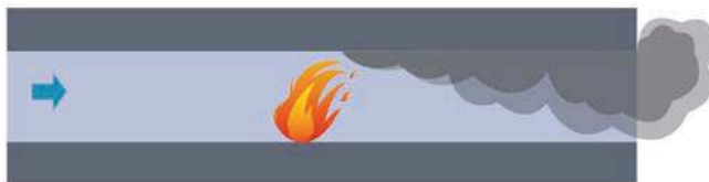
Imagen 8. Progresión del humo en un túnel con un flujo de aire mayor de 3 m/s
