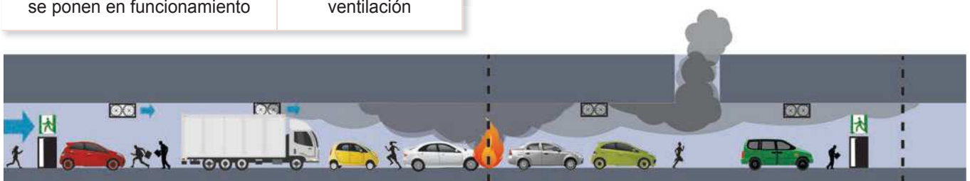
Imagen 3. Túnel de ventilación longitudinal con extracción masiva de humo
