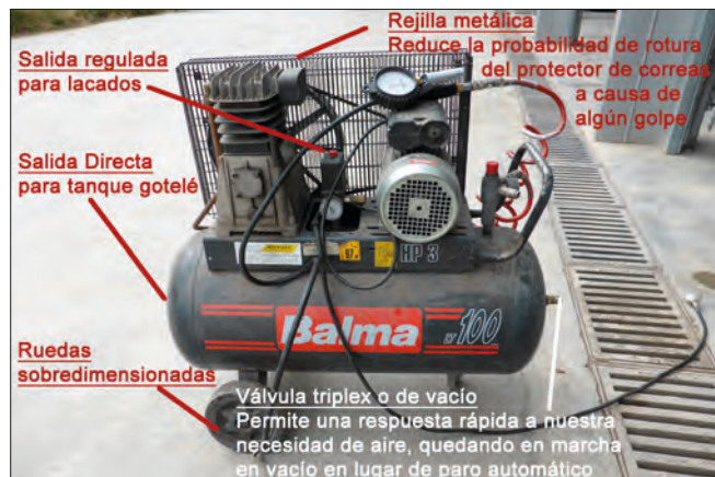
Imagen 30. Partes de un compresor de aire
