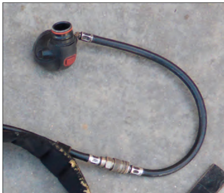
Imagen 26. Conexión de la válvula pulmoautomática
