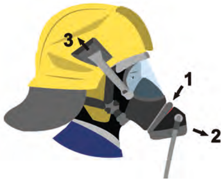
Imagen 11. Desacoplamiento del dispositivo automático de la máscara
