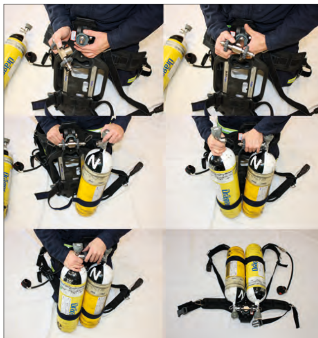
Imagen 23. Colocación del Adaptador "T"
