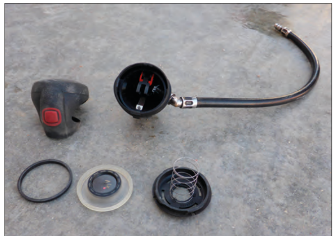
Imagen 27. Desmontaje del pulmo PA90 - 1
