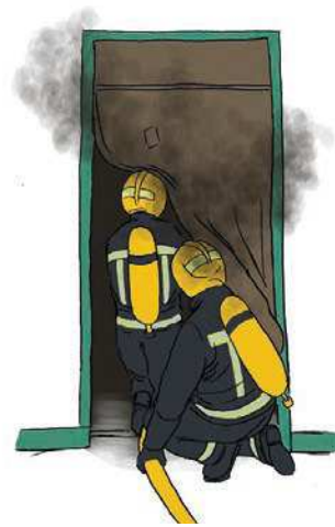
Imagen 105. Empleo de cortina de bloqueo de humo en el acceso a un incendio
