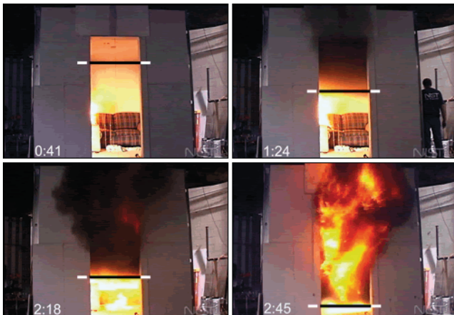
Imagen 21. Evolución de un incendio. Las dos imágenes superiores corresponden a un Incendio Limitado por el Combustible (ILC). En la última imagen (2:45) se aprecia claramente un Incendio Limitado por la Ventilación (ILV)
