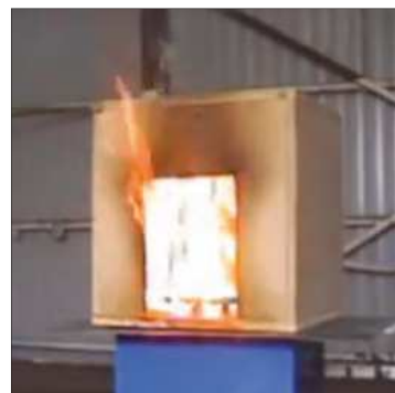
Imagen 74. Clásico ejercicio en "casa de muñecas". La aplicación del spray de agua al interior desplaza los gases de incendio al exterior que se inflaman al contacto con el aire
