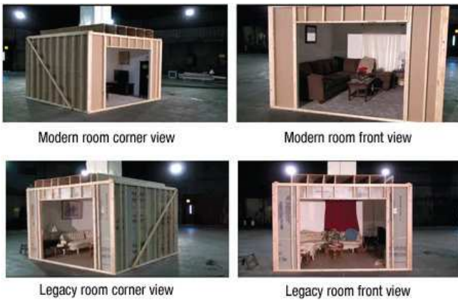
Imagen 5. Detalle de la configuración del experimento de comparación de combustible moderno y tradicional
