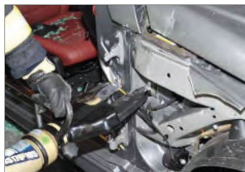
Imagen 295. Corte superior del montante A
