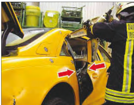
Imagen 202. Procedimiento de retirada de las puertas traseras por el lado de la cerradura
