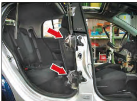
Imagen 314. Recubrimiento de cantos afilados con cubiertas protectoras
