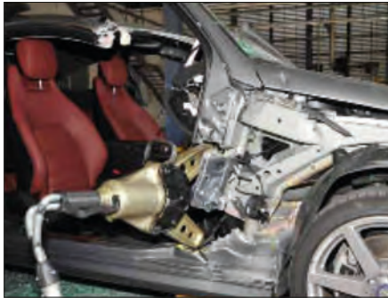
Imagen 299. Aplicación del separador entre el montante A y el faldón lateral
