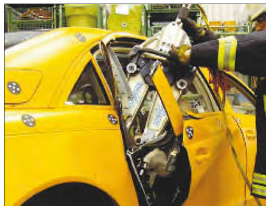
Imagen 202. Procedimiento de retirada de las puertas traseras por el lado de la cerradura
