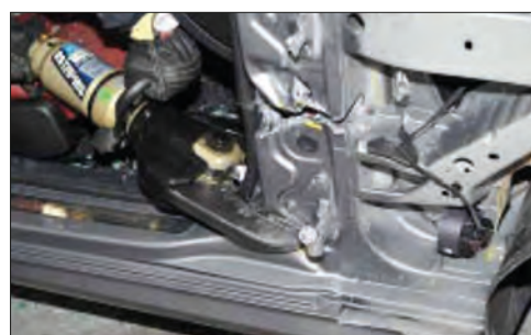
Imagen 296. Corte inferior del montante A
