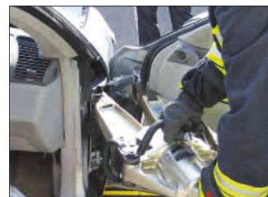
Imagen 218. Retirada de la puerta delantera
