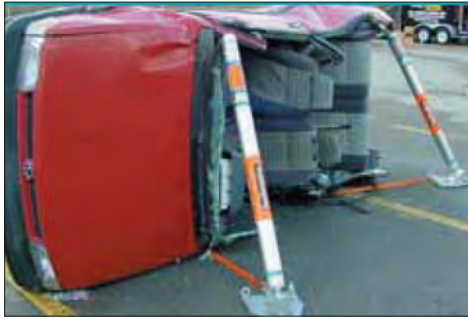
Imagen 153. Estabilización del techo
