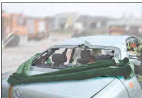
Imagen 140. Colocación de eslingas en vehículo siniestrado
