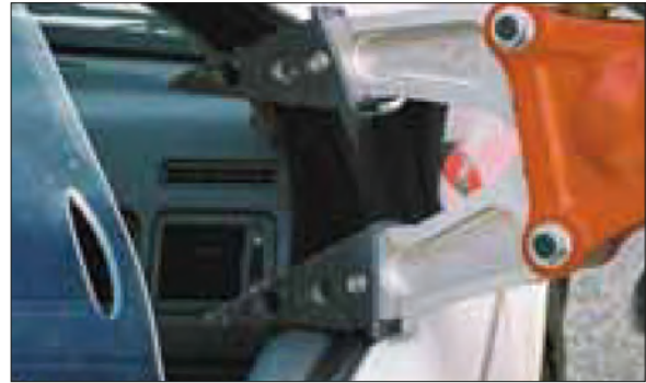
Imagen 198. Apertura de hueco actuando contra el montante A
