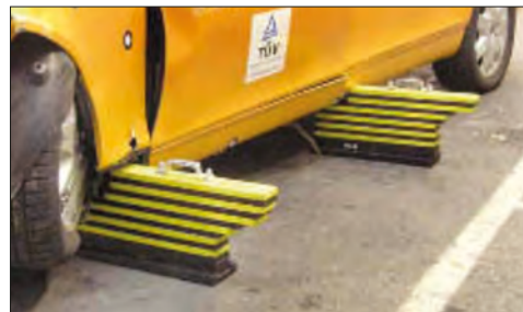
Imagen 147. Apoyar por debajo con bloques corredizos para bajos del vehículo
