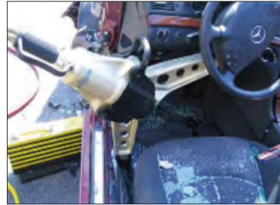
Imagen 301. Presión de la columna de dirección desde el lado del conductor
