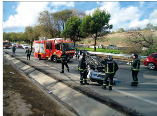
Imagen 104. Vehículos estacionados en posición de seguridad (parapeto)
