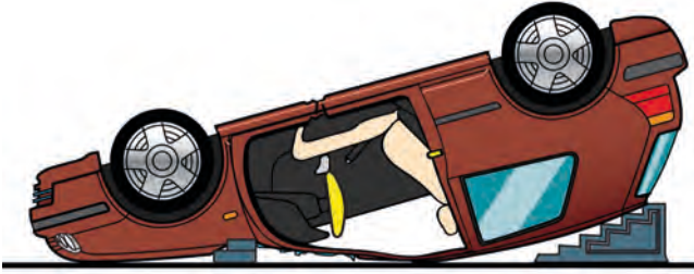
Imagen 226. Retirada de puerta delantera
