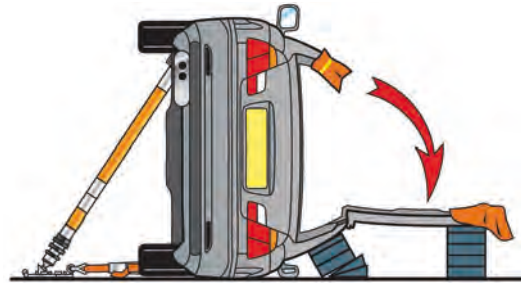
Imagen 267. Estabilización del vehículo para el abatimiento del techo sobre el costado
