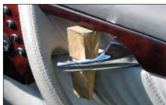
Imagen 193. Colocación de cuña bajo el accionamiento interior
