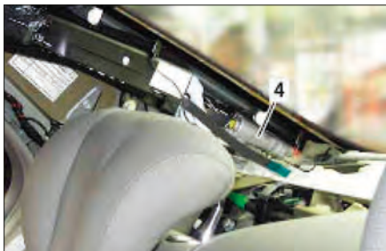
Imagen 254. Generador de gas del montante C (4)
