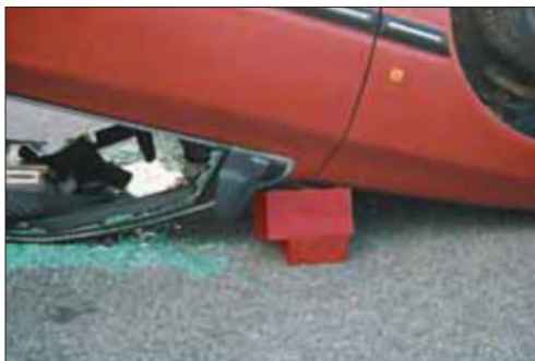
Imagen 159. Uso de bloques adicionales
