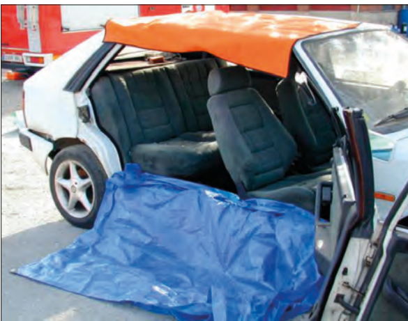
Imagen 99. Protección con lonas
