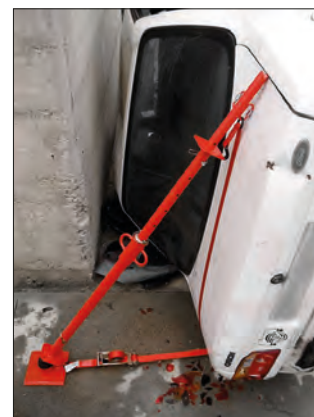
Imagen 169. Estabilización de vehículo de accesibilidad reducida
