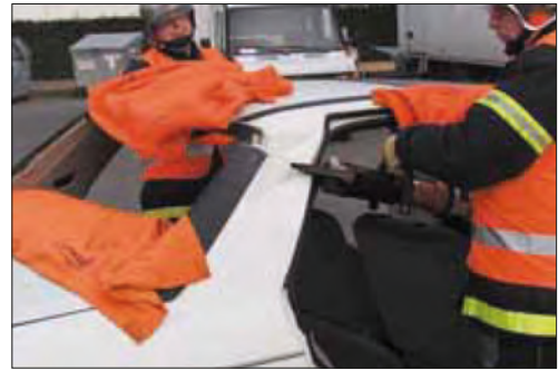
Imagen 260. Corte de los pilares B y C
