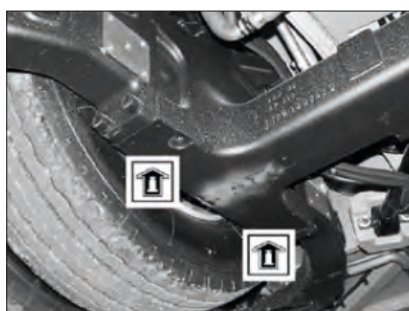
Imagen 164. Ejes (soporte de fuelles neumáticos)
