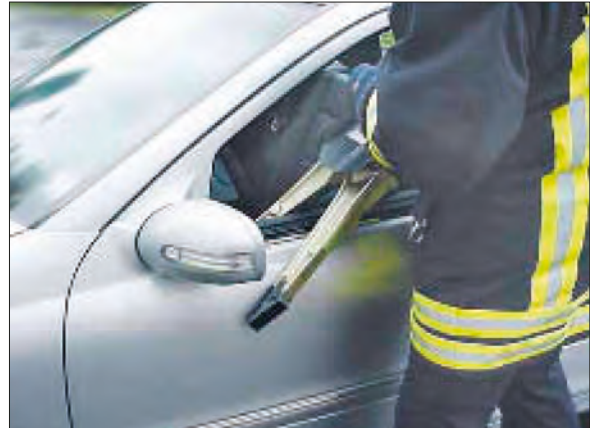
Imagen 199. Apertura de puertas por las bisagras con el separador desde arriba
