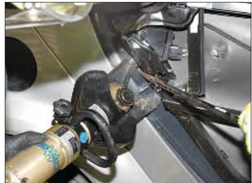
Imagen 309. Corte del estribo de cierre de la cerradura de la puerta
