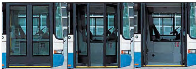
Imagen 347. Puertas basculantes que se abren hacia el interior
