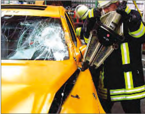
Imagen 196. Aplastamiento de aleta con separador para crear hueco o para la eliminación de la puerta
