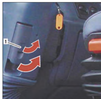
Imagen 333. Desbloqueo manual con seguro mecánico
