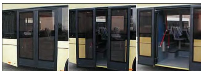
Imagen 348. Puertas basculantes que se abren hacia fuera
