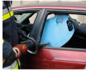
Protección en el corte de montantes
