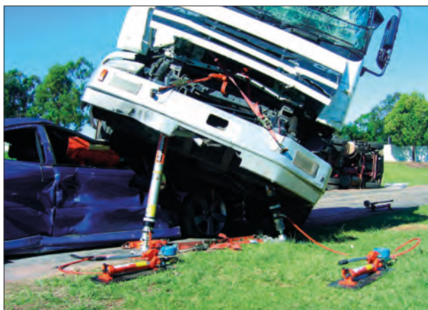
Imagen 168. Estabilización solidaria de varios vehículos
