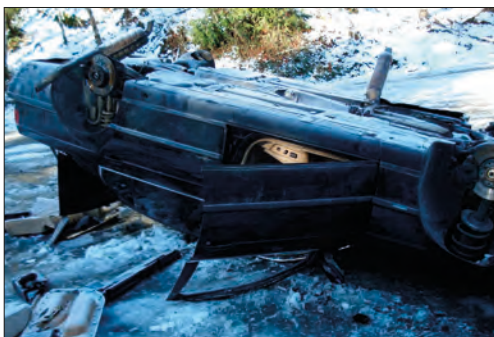
Imagen 155. Vehículo con techo colapsado
