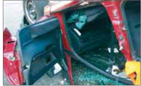
Imagen 230. Retirada de la puerta
