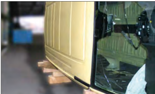
Imagen 154. Estabilización de furgoneta con cuñas
