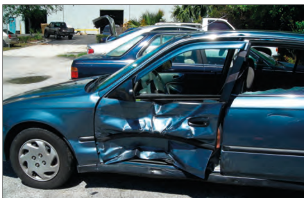
Imagen 4. Transmisión de fuerzas debidas a la dirección del impacto
