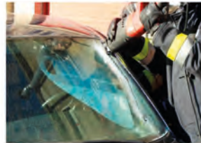
Protección en el corte de cristal laminado
