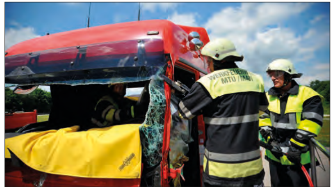
Imagen 335. Primer corte de descarga en el tercio superior de descarga
