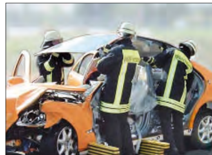
Imagen 256. Retirada del techo
