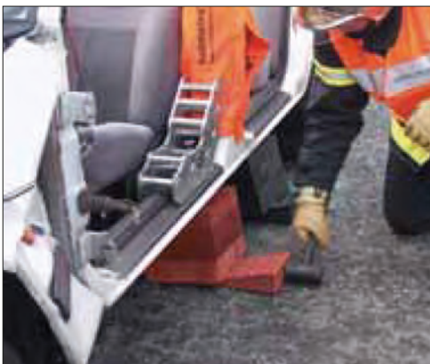
Imagen 285. Colocación de estabilización debajo del pilar B
