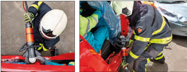
Imagen 212. Cortes del pilar B
