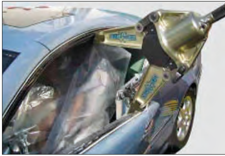
Imagen 190. Aplicación del separador entre la puerta y el marco de cristal
