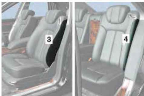
Imagen 175. Airbag lateral delantero (3) y airbag lateral trasero (4)
