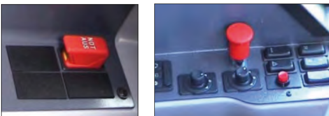
Imagen 117. Interruptor NOT AUS
