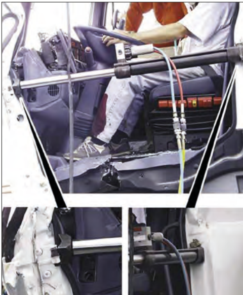
Imagen 338. Instalación del cilindro de rescate
