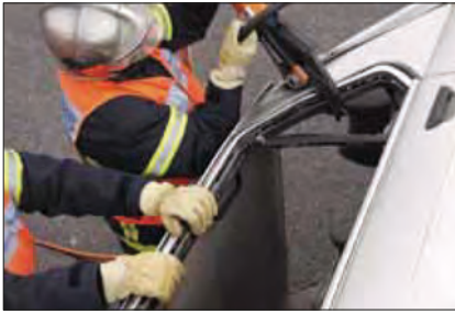
Imagen 271. Corte del pilar C
