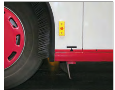
Imagen 166. Puntos de apoyo de autocares y autobuses
