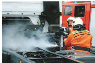
Imagen 113. Insuflación de CO 2 en la aspiración de aire externa
