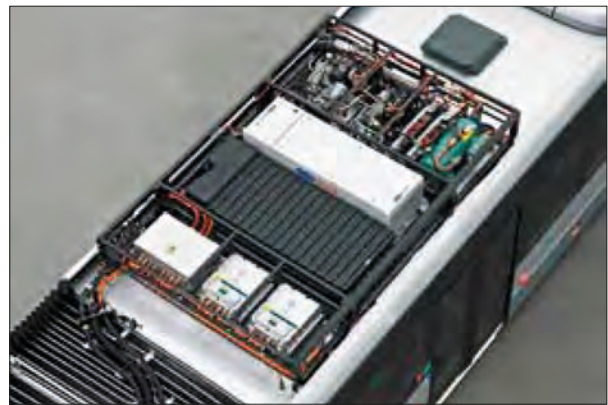
Imagen 42. Grupos auxiliares de accionamiento eléctrico y baterías
