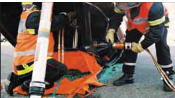
Imagen 278. Corte de pilares B y C
