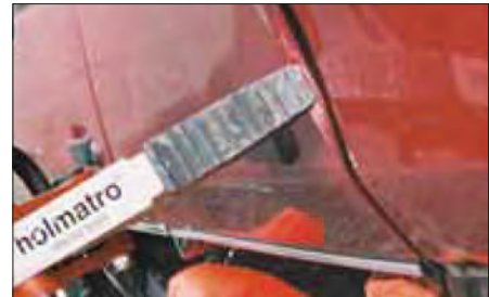
Imagen 231. Realización de abertura a la altura de la cerradura
