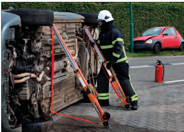
Imagen 149. Utilización de puntales para la estabilización del vehículo
