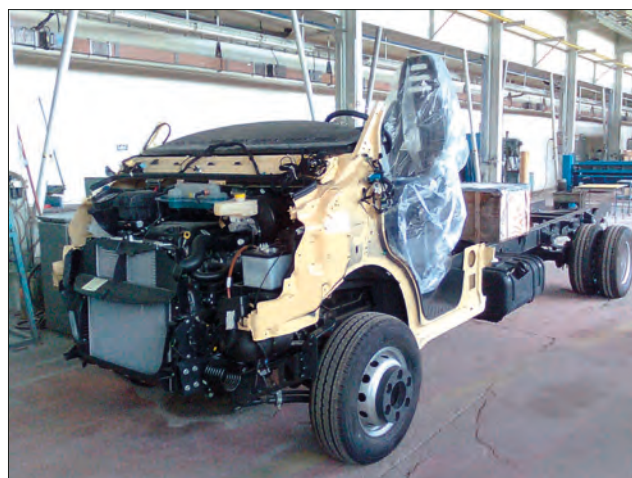
Imagen 26. Bastidor de vehículo de transporte de pasajeros
