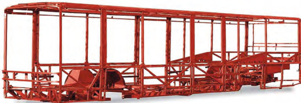
Imagen 25. Estructura de autobús urbano con refuerzo longitudinal
