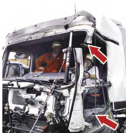
Imagen 341. Cortes de descarga (flechas) y cilindros colocados
