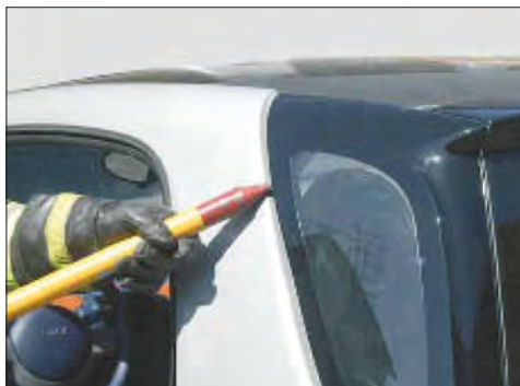
Imagen 186. Extracción de cristales con palanqueta
