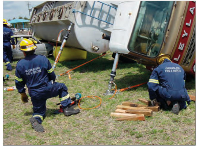
Imagen 165. Colocación de puntos de apoyo
