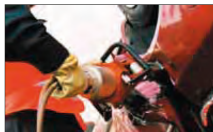
Imagen 232. Separación de la puerta de su estructura
