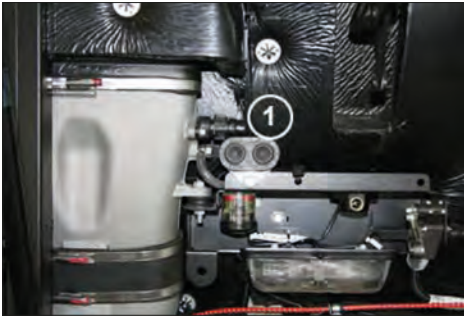
Imagen 110. Pulsador arranque/parada del motor (1) en el compartimento del motor
