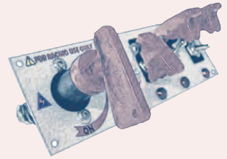
Imagen 118. Distinción del Interruptor NOT AUS y el pulsador de bloqueo de frenos
