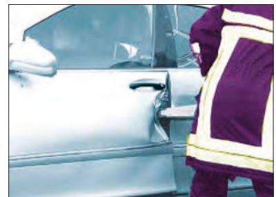
Imagen 188. Apertura de cerradura utilizando separador
