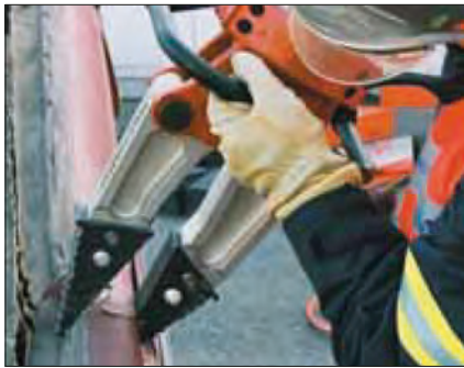
Imagen 227. Compresión del riel del suelo para hacer una abertura
