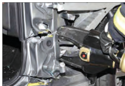
Imagen 297. Corte de descarga en el interior del larguero inferior
