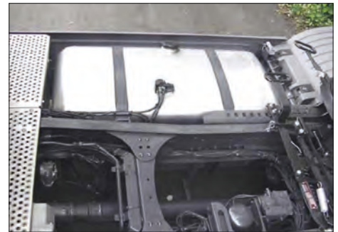
Imagen 115. Posible punto de corte de tubería de combustible
