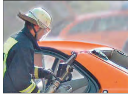
Imagen 255. Corte del montante C
