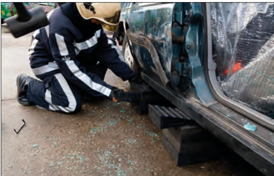
Imagen 143. Refuerzo en la parte central interna con bloques
