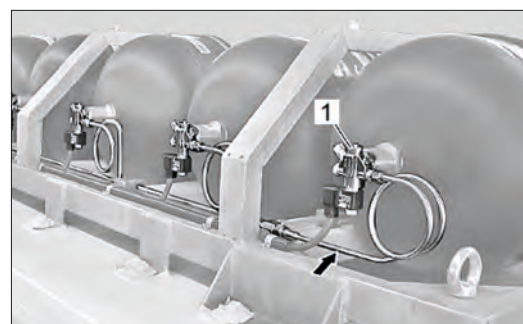
Imagen 136. Tanques de gas
