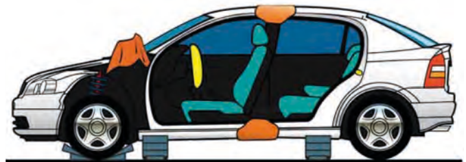
Imagen 210. Retirada de un lateral
