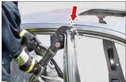
Imagen 253. Corte del montante B con refuerzos estructurales
