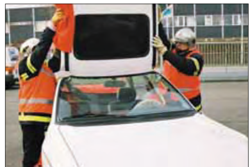
Imagen 262. Maniobra de abatimiento del techo hacia delante
