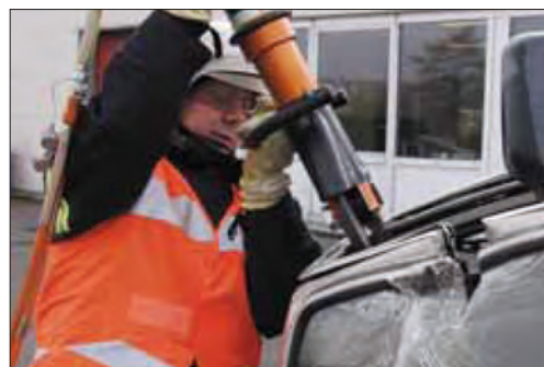
Imagen 270. Corte del pilar B
