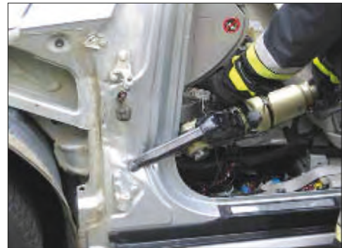
Imagen 287. Corte de alivio en la base del pilar A
