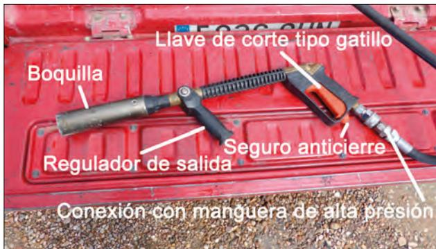
Imagen 23. Partes de la pistola de alta presión Pickup
