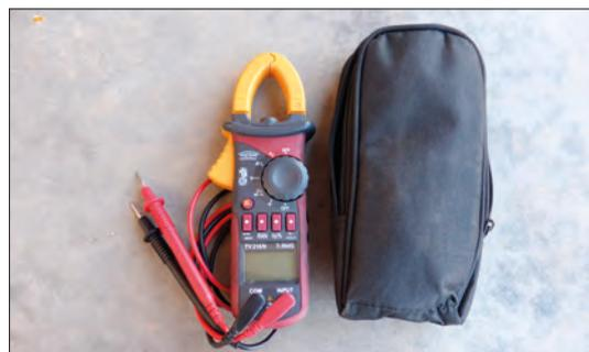
Imagen 24. Pinza amperimétrica
