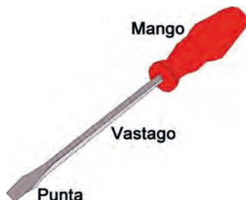
Imagen 23. Partes de un destornillador
