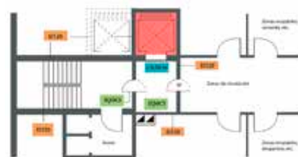
Imagen 393. Escaleras especialmente protegidas
