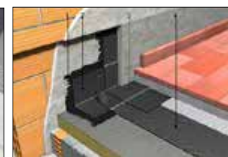
Imagen 417. Encuentro cubierta con parámetro vertical
