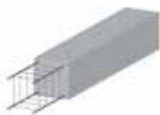
Imagen 300. Vigüetas in situ
