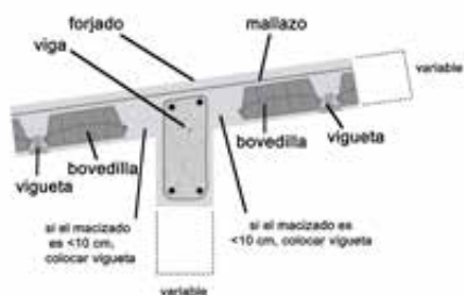
Imagen 371. Forjado unidireccional
