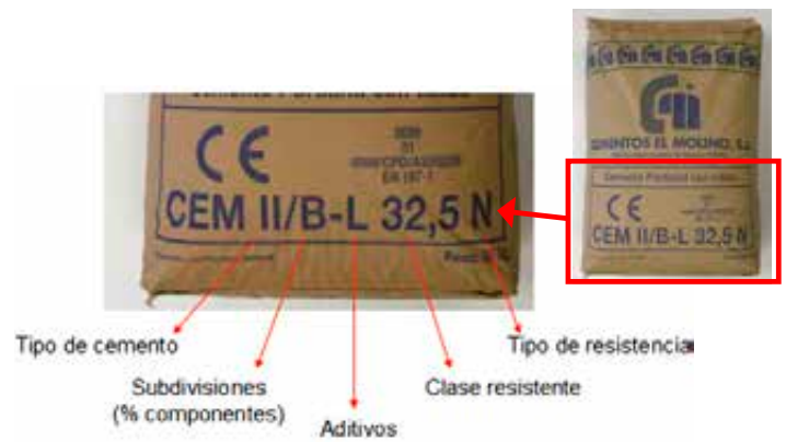
Imagen 57. Nomenclatura del cemento
