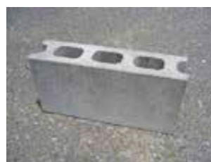
Imagen 117. Bloque de hormigón
