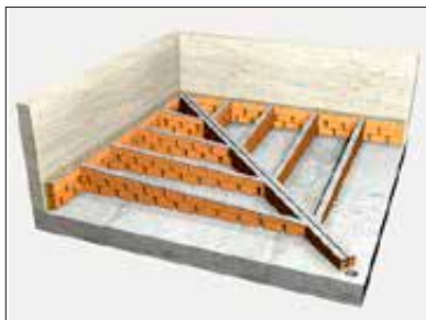
Imagen 380. Cubierta plana fábrica
