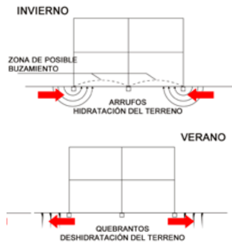
Imagen 436. Comportamiento de un suelo expansivo
