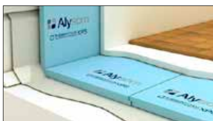
Imagen 410. Cubierta invertida a base de PVC (Impermeabilizante, en gris) y poliuretano extruido (aislante, en azul)
