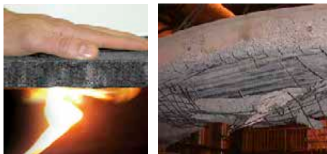
Imagen 451. Comportamiento al fuego del hormigón
