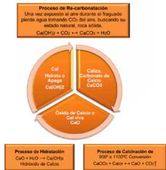
Imagen 55. Proceso de Re-carbonatión / Calcinación / Hidratación
