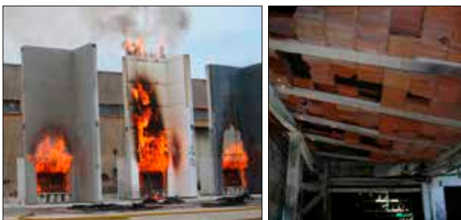
Imagen 453. Comportamiento al fuego del hormigón pretensado
