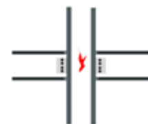
Grietas en el alma
