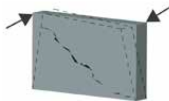
Imagen 649. Aplastamiento diferencial (alabeo)
