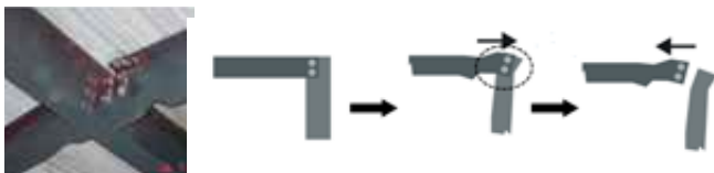
Imagen 664. Ruptura de conexión por enfriamiento
