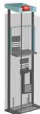
Imagen 14. Ascensor eléctrico sin cuarto de máquinas
