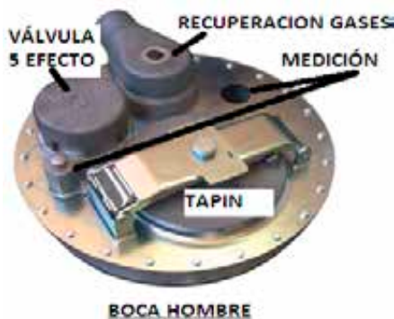
Imagen 127. Boca de hombre hidrocarburos
