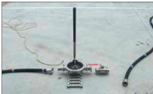
Imagen 257. Montaje de bomba de trasvase manual
