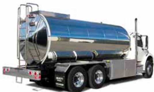
Imagen 201. Cisterna de forma circular
