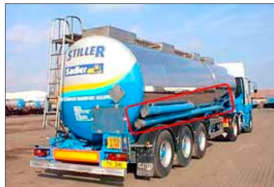
Imagen 161. Tubos descarga sólidos
