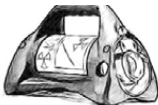
Imagen 54. Gammagrafo. Bulto tipo B
