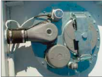
Imagen 167. Válvula recuperación de vapores
