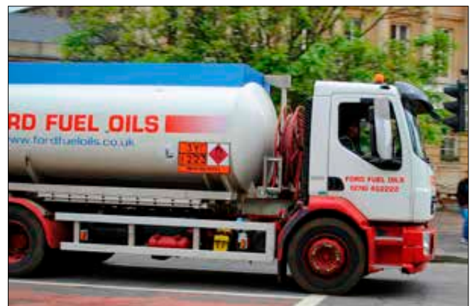
Imagen 120. Cisterna de hidrocarburos. Sin aislamiento
