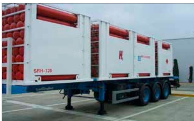
Imagen 111. Cuatro cuadros destinados al transporte de hidrógeno
