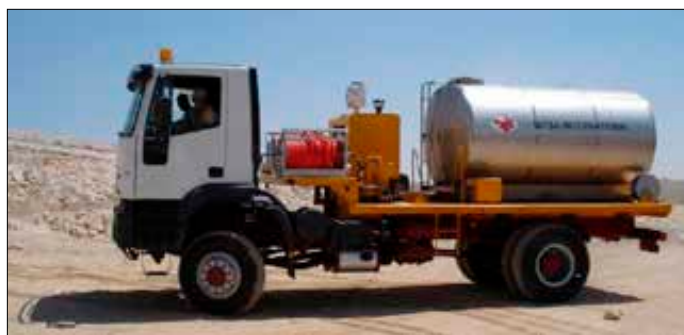
Imagen 204. Cisterna con compresor
