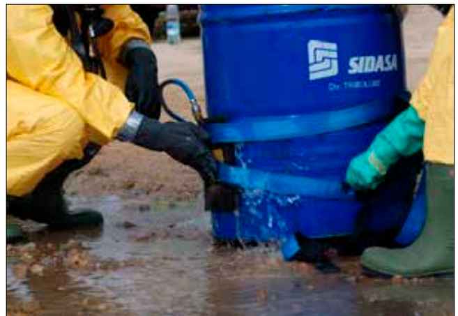
Imagen 255. Taponamiento de escape en contenedor
