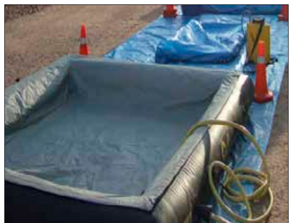
Imagen 284. Estación de descontaminación
