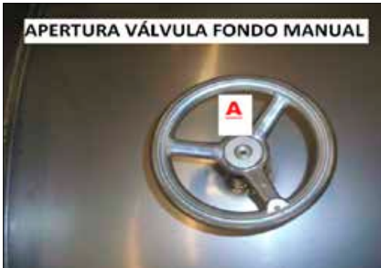
Imagen 143. Llave apertura superior de válvula de fondo
