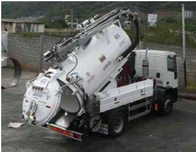
Imagen 116. Cisterna que opera al vacío
