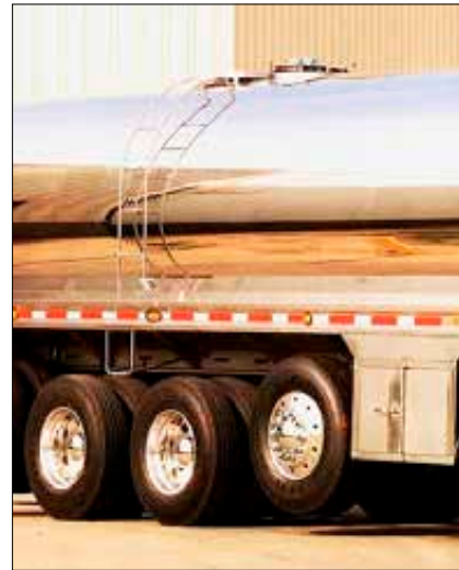
Imagen 158. Escaleras de camión cisterna
