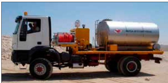
Imagen 163. Compresor de cisterna
