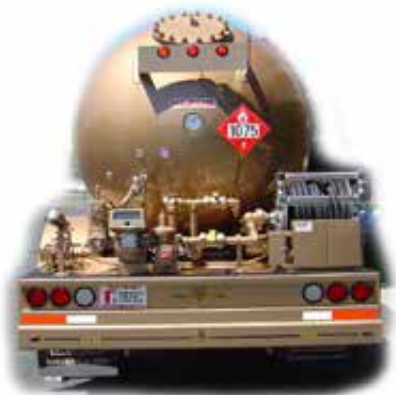
Imagen 131. Cisterna butano con orificio de limpieza (presiones rondan los 20 bares)
