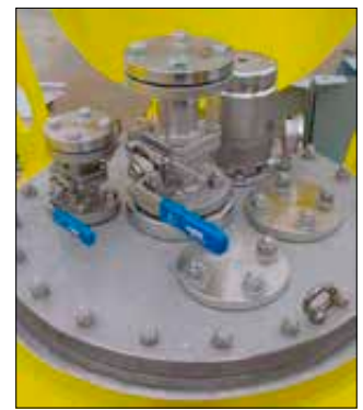
Imagen 108. Orificios y las válvulas de manipulación de cisterna portátil
