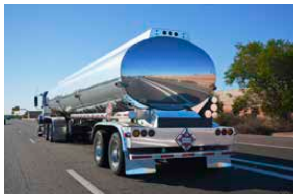
Imagen 200. Cisterna de forma elíptica
