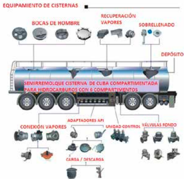
Imagen 126. Equipamiento de cisternas.
