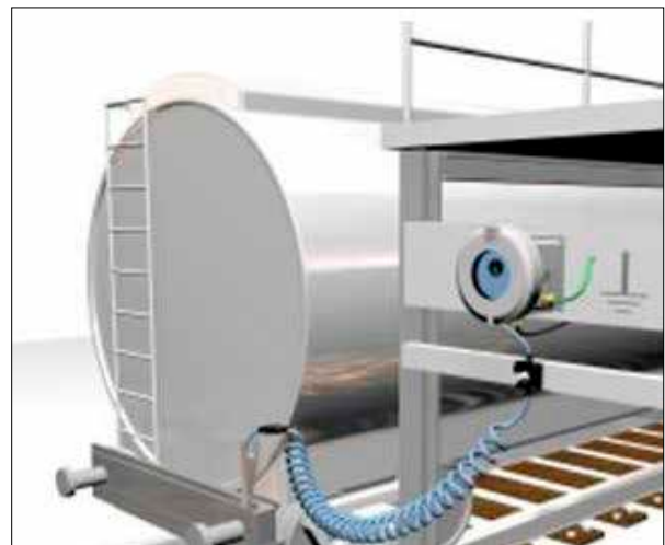
Imagen 169. Toma de tierra
