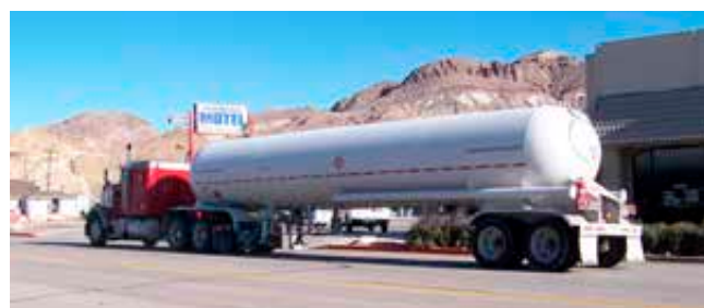
Imagen 103. Cisterna sin compartimentar
